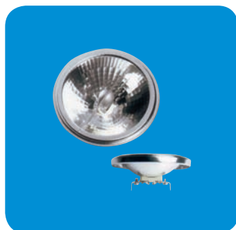
LA 543745 Halogen-Leuchtmittel / halogen lamp QRB 111 warm weiß / warm white, 2700K 12V G53/75W, 45°, Ø 11,1cm
