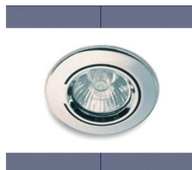
PN 84108 Einbauset / Downlight PROFESSIONAL Hoch-volt / high-volt Chrom-satin / chrome-satin 1x GU10/230V/50W Ø 83mm, Tiefe / depth 82mm
